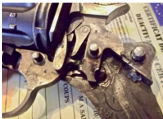
Nous avons pris l'exemple de ce revolver Mle 1892. Tout est bloqué, le barillet ne tourne pas, ne bascule pas et on voit à l'intérieur les soudures qui empêchent la cinématique des mécanismes de fonctionner. Le canon comporte une large fente dans le sens de la longueur. C'est devenu un revolver «*Canada Dry* : il ressemble à un Mle 1892, mais ce n'est plus le 1892 mais un presse papier, cher. »
